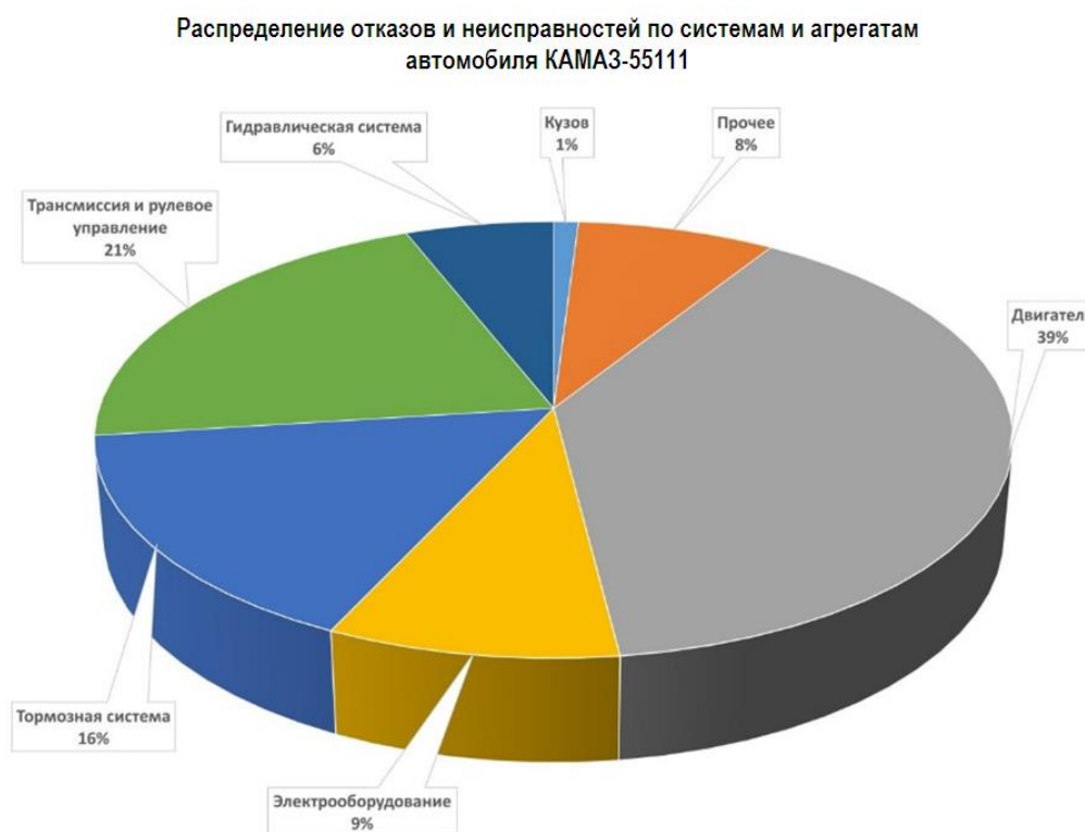
Рисунок 1.1 – Диаграмма отказов систем и агрегатов автомобилей КАМАЗ-55111
