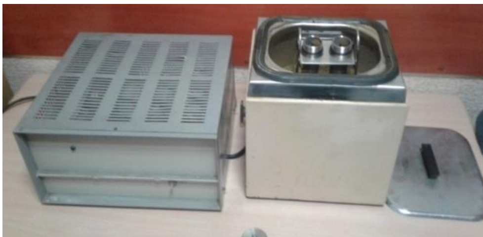
Рисунок 3.12 – Ультразвуковая ванна ОЗУ-025 с образцами разработанной РЭД
