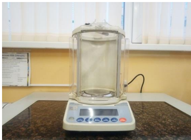
Рисунок 3.9 – Аналитические весы HR-250 AZG
