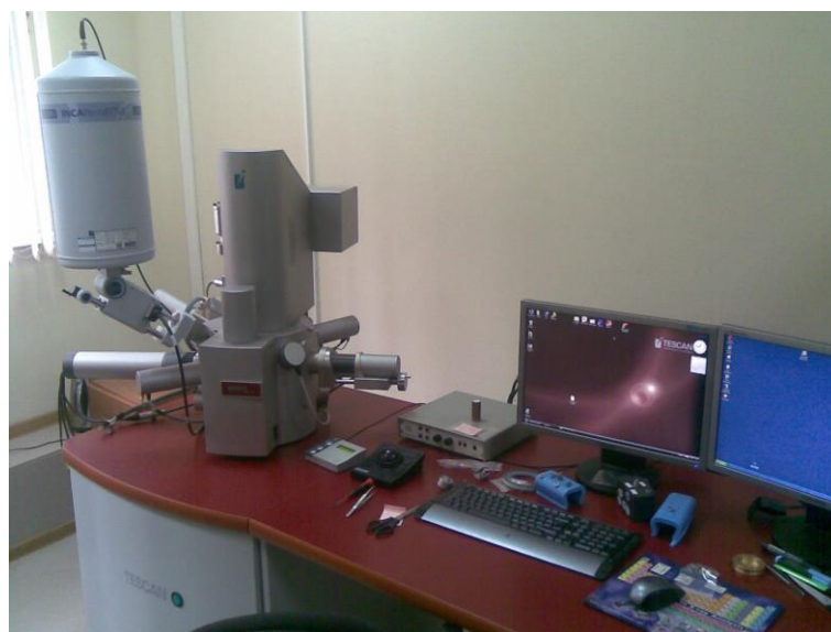
Рисунок 3.10 – Исследовательский комплекс MIRA II TESCAN
