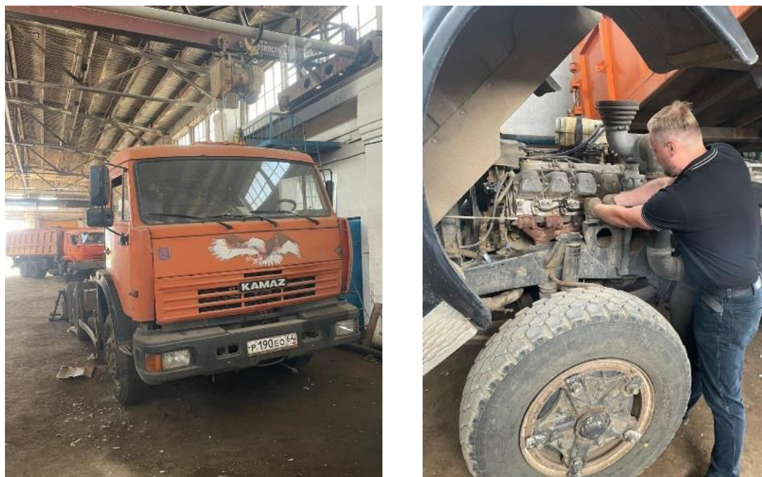
Рисунок 3.15 – Диагностика экспериментальных двигателей при проведении эксплуатационных испытаний разработанной РЭД
